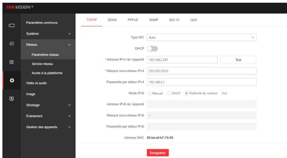
Fig. 4 : Configuration réseau.
