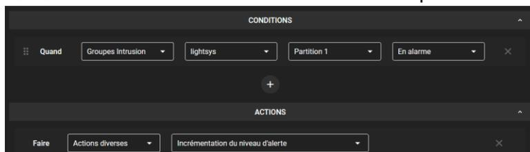
Fig. 34 : Incrémentation niveau d'alerte si partition 1 en alarme.
